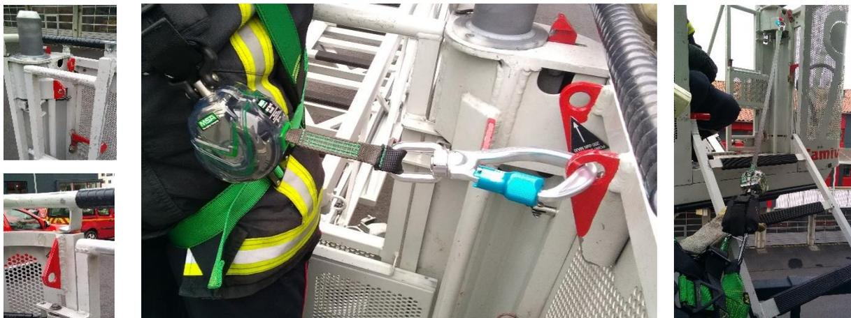
Les points d'ancrage (**identifiés en rouge**) dans la plateforme : autant de points de fixation pour le connecteur de l'autoroll
